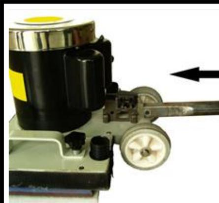
ACTIVE Edge Maschine aus der Verpackung entnehmen und die Handgriff-Stange so in den Sockel einstecken, dass das Schraubenloch mittig sitzt. Schraube, Mutter und Unterlegscheibe anbringen und dann mit dem beiliegenden Schraubenschlüssel befestigen.
