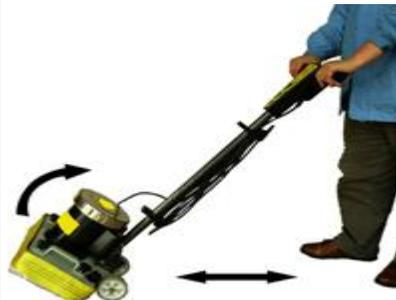
Um die Maschine auf den Rollen transportieren zu können muss die Griffstange senkrecht aufgestellt werden und eingerastet sein. Dann Griffstange soweit nach unten drücken, bis die Maschine leicht nach hinten kippt und über die Rollen angehoben wird.
