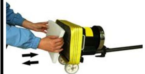
Die Maschine wie dargestellt auf dem Boden ablegen und anschließend das Scheuerpad an der Bodenplatte anbringen. Auf richtigen Sitz achten!
